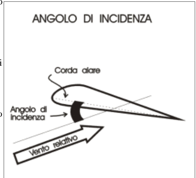
Figura 3-9. L'angolo di incidenza: un piccolo angolo dai grandi effetti
