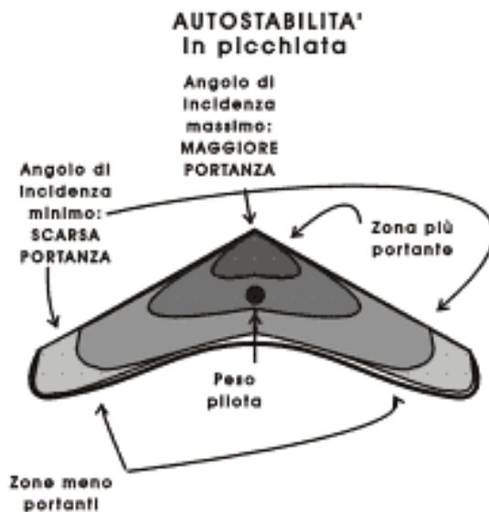
Figura 5-33. Durante la picchiata, invece, la portanza si sviluppa nella parte centrale.
