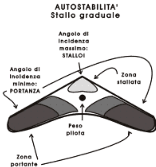
Figura 5-32. Le estremità alari sviluppano ancora portanza quando la parte centrale è già stallata.
