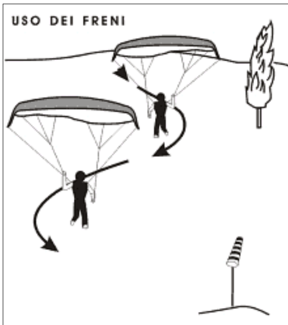
Figura 6-11. Anche correndo sul prato è possibile pilotare la vela agendo sui freni: è molto utile saggiarne la risposta fin dai primi esercizi.
