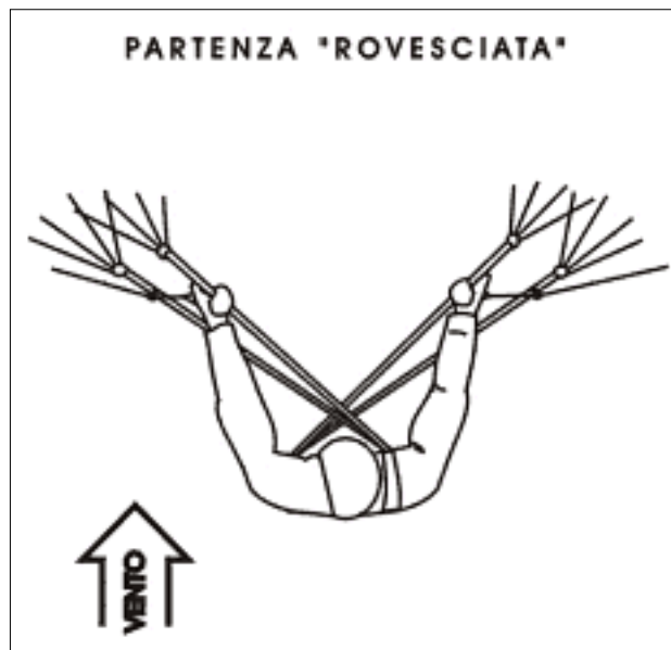
Figura 6-14. Come impugnare elevatori anteriori e freni per il gonfiaggio "rovesciato".
