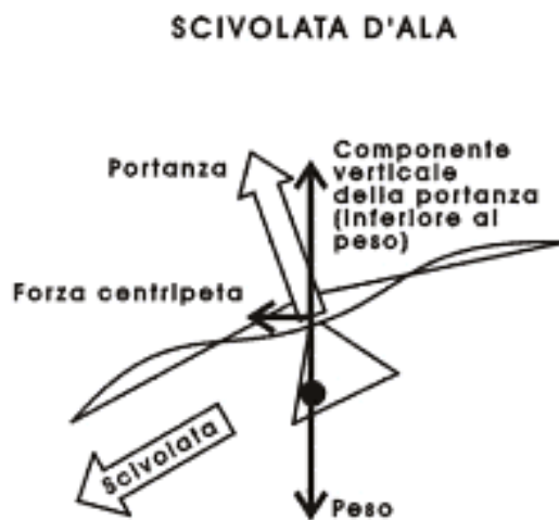
Figura 5-24. La scivolata d'ala per mancata (od insufficiente) cabrata.
