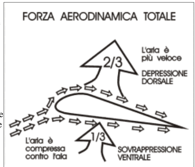
Figura 3-10. Genesis della Forza Aerodinamica Totale, che rende possibile il volo.
