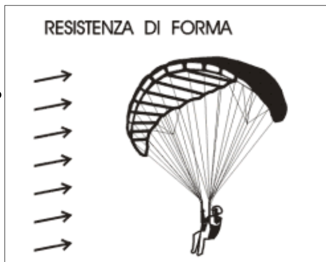
Figura 3-12. Resistenza di forma: cresce al crescere della velocità ed è proporzionale alla superficie esposta al vento relativo.
