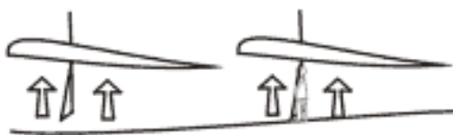
Figura 5-13. I due tempi del sollevamento del deltaplano: A=porlo orizzontale; B=sollevarlo dal suolo.
