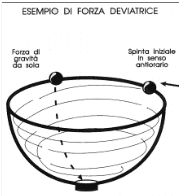
Figura 4-24. Una piccola spinta laterale determina un movimento rotatorio sulla pallina sottoposta alla forza di gravità.
