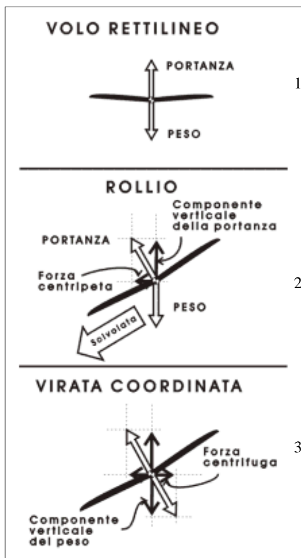
Figura 3-22. La cabrata ha l'effetto di riequilibrare le forze impedendo la scivolata d'ala.
