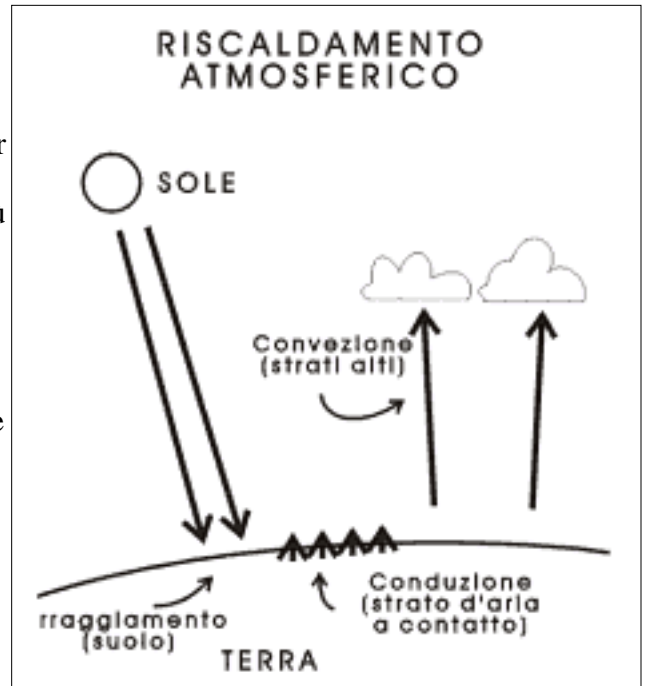
Figura 4-6. Formazione del gradiente termico verticale dell'atmosfera.
