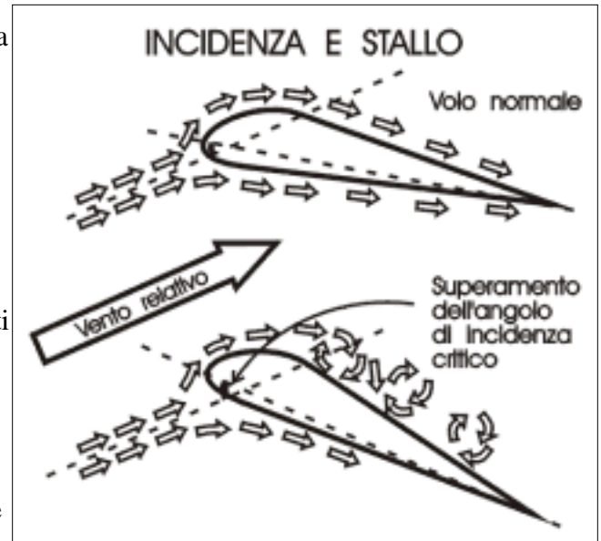
Figura 3-19. Lo stallo si verifica quando i filetti fluidi perdono la loro aderenza e si distaccano dall'estradosso.
