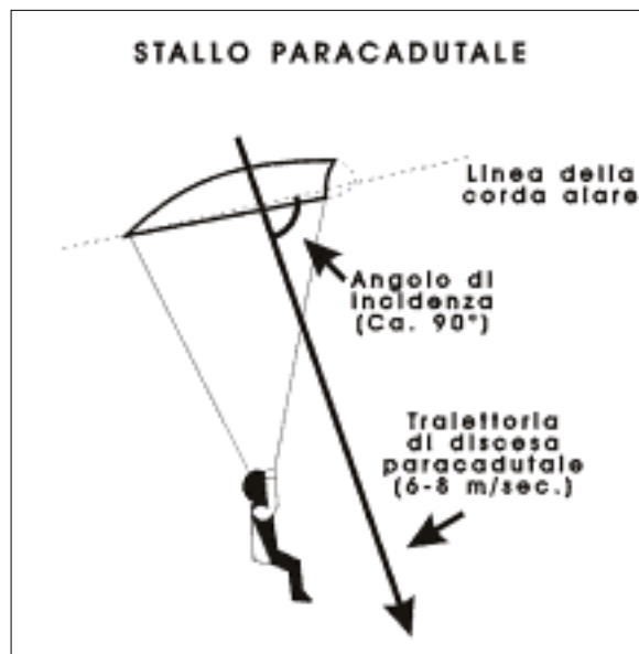
Figura 6-29. Durante lo stallo paracadutale l'angolo di incidenza (prossimo ai 90°) non permette lo sviluppo di portanza. È indispensabile far verificare attentamente la vela, individuandone il difetto.
