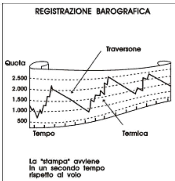
Figura 7-3. Registrazione barografica di un volo: sono riportate le quote ed i tempi.
